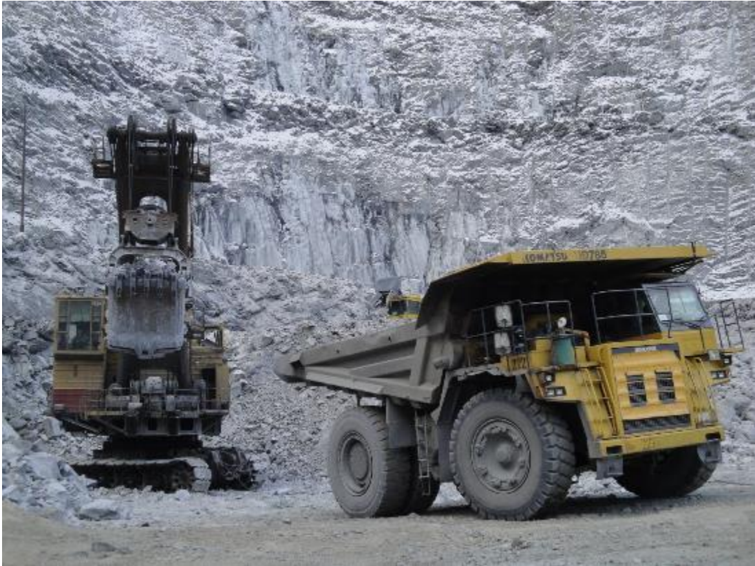
Նկար 7. Բացահանքում ինքնաթափ բեռնող էքսկավատորի օրինակ
