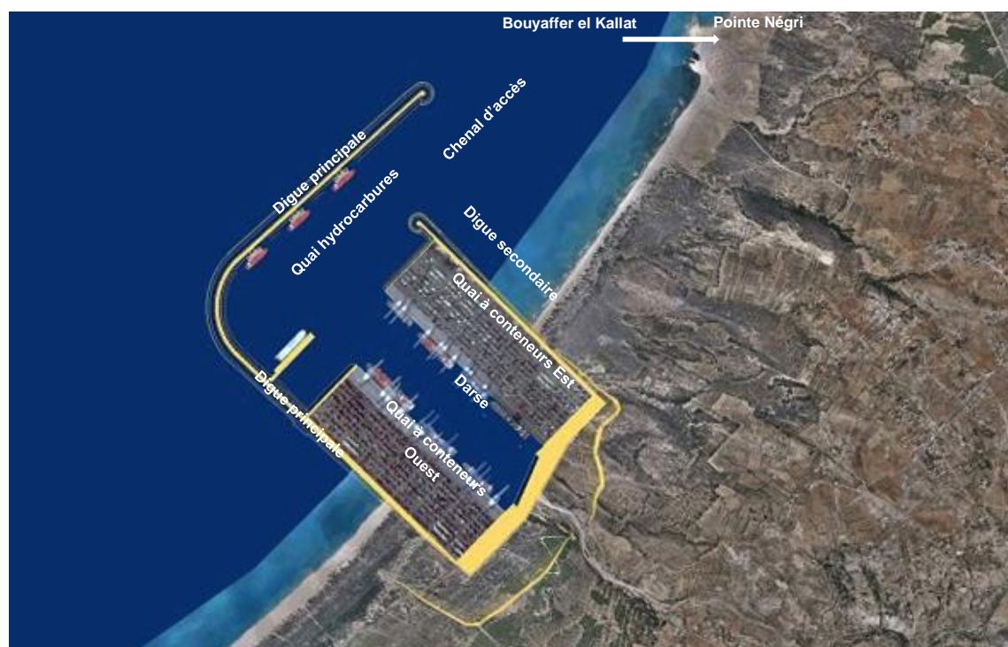
Figure 2 : Vue schématique de l'insertion du port dans le site et de ses principaux ouvrages
